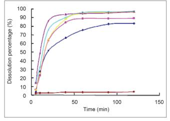
Fig. 2: Dissolution profiles evodiamine solid dispersions Dissolution profiles of EV-EC (-•-) and different ESEV:PVP-K<sub>30</sub> weight ratios of SDEV-EC containing the 1:2 -•-, 1:4 (- $\blacksquare$ -), 1:6 (- $\blacktriangle$ -), 1:8 (- $\times$ -), and 1:10 (- $\ast$ -).
